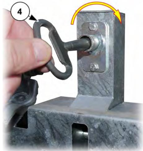
Abb. 28: Notentriegelung der Etagensicherungstür
