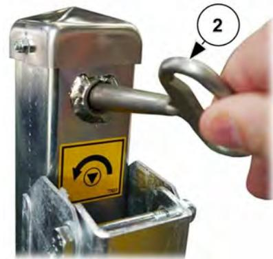
Abb. 36: Notentriegelung der Schranke mit elektromechanischer Verriegelung
