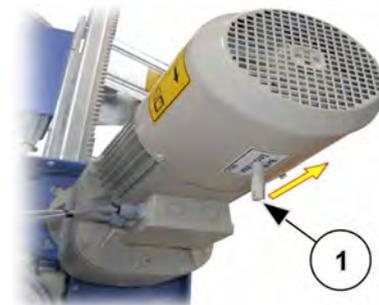
Abb. 79: Bremslüfthebel ziehen
