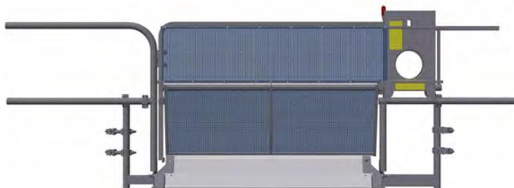
Abb. 42: Etagensicherungstür "Comfort" geschlossen (Lochblech)
